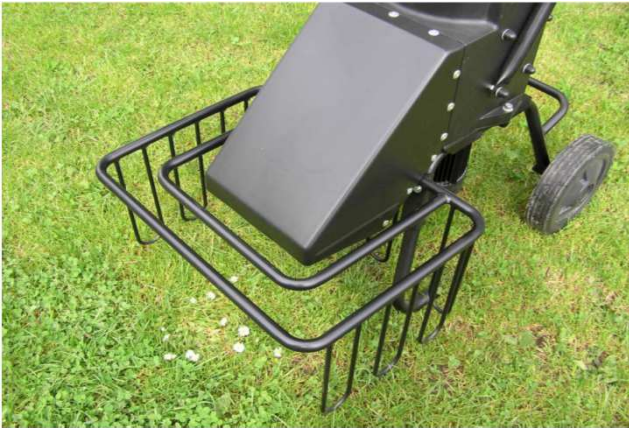
1 Eingreifschutz, Ansicht oben
