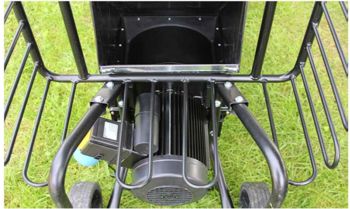
2 Eingreifschutz, Ansicht unten
